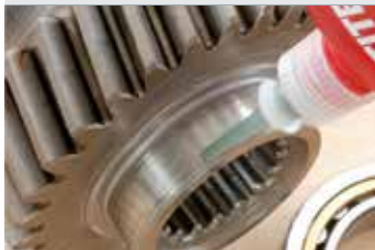
Poleas, engranes, rotores, bujes, y tapones en sus alojamientos.
